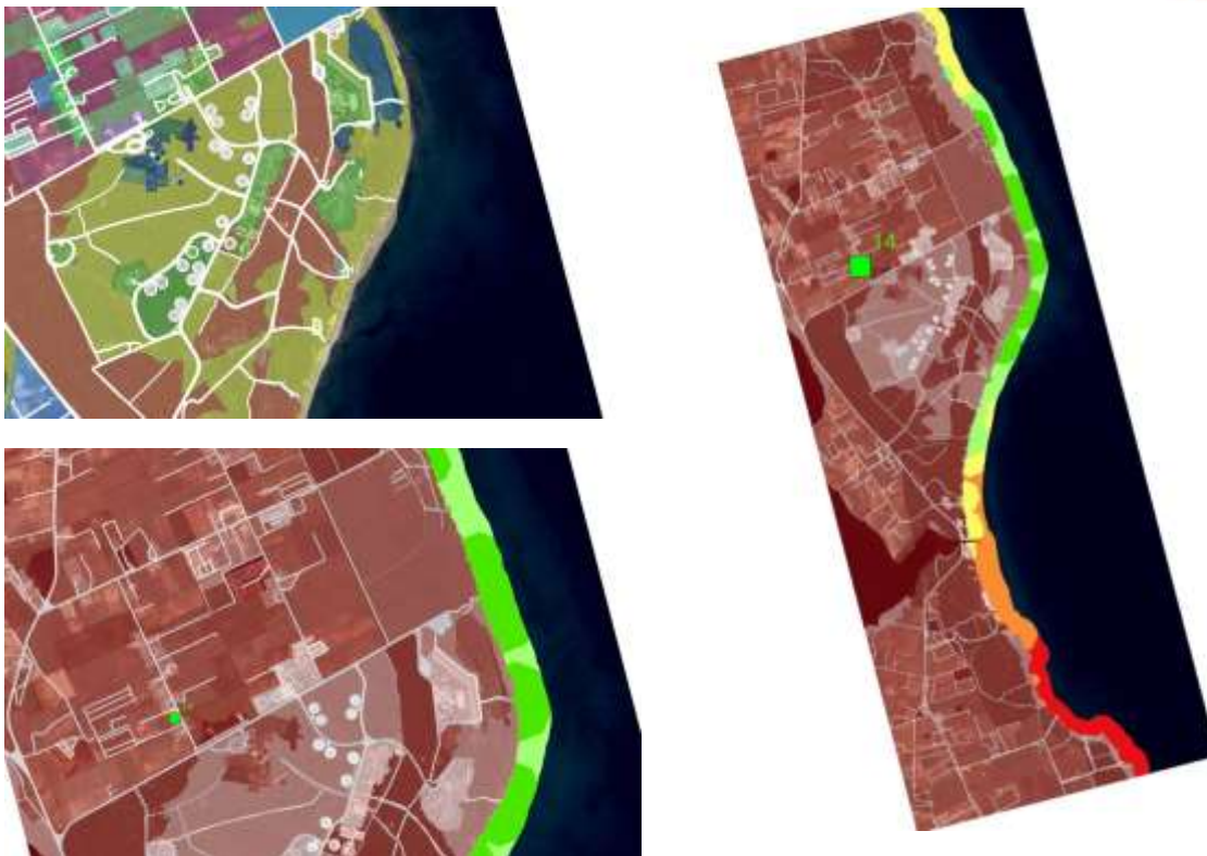
Fig. 2 - Esempio di visualizzazione del “cruscotto direzionale” che sulla base di dati e modelli (in alto a sinistra, carta dell’uso del suolo, sentieristica e rete stradale) fornisce indicazioni sulla “raggiungibilità” per ogni singola struttura. La zonazione in scala di verdi fornisce un valore di maggiore (verde scuro) o minore (verde chiaro) “raggiungibilità” della spiaggia rispetto alla struttura 14. Infine integrando scenari evolutivi dell’evoluzione della linea di riva ed il fatturato giornaliero per ogni singola struttura viene fornito il valore economico della costa (zonazione in scala di rossi).
